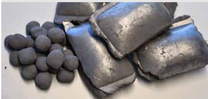
Järnsvampspelletts (DRI – Direct Reduced Iron) och järnsvampsbriketter (HBI – Hot Briquetted Iron).
