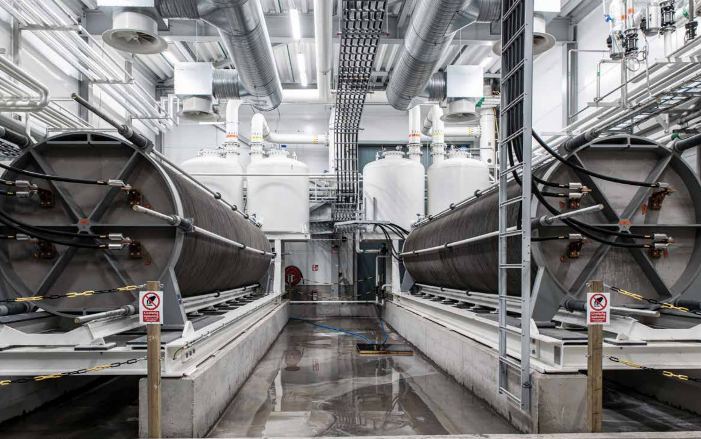
Alkaliska elektrolysörer producerar all vätgas som används vid pilotanläggningarna för direktreduktion och vätgaslagring.
